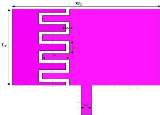
Fig 2: (a) design parameters of meander line:  $L_p=19.2\text{mm}$ ,  $W_p=12.4\text{mm}$ ,  $w=0.5\text{mm}$ ,  $a=3\text{mm}$ ,  $b=4\text{mm}$
