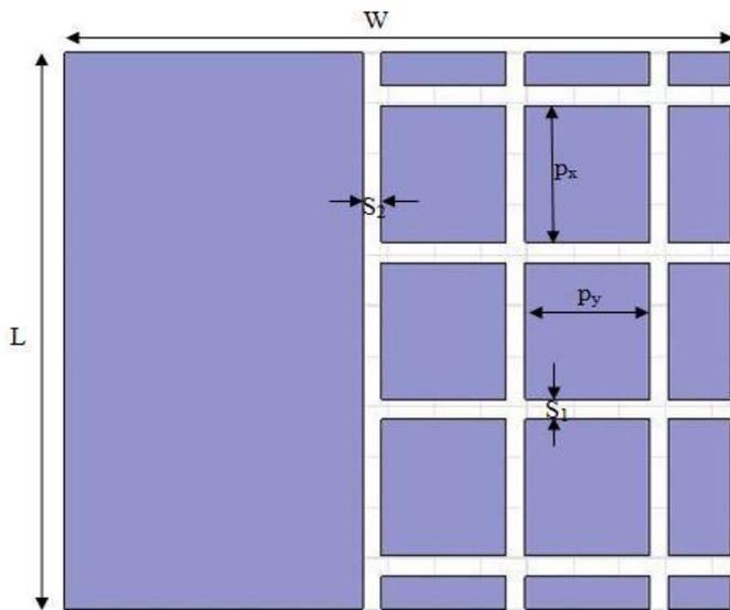
Fig 2: (b) design parameters of PDGS:  $S_1=0.8\text{mm}$ ,  $S_2=0.7\text{mm}$ ,  $p_x=4.6\text{mm}$ ,  $p_y=4.2\text{mm}$
