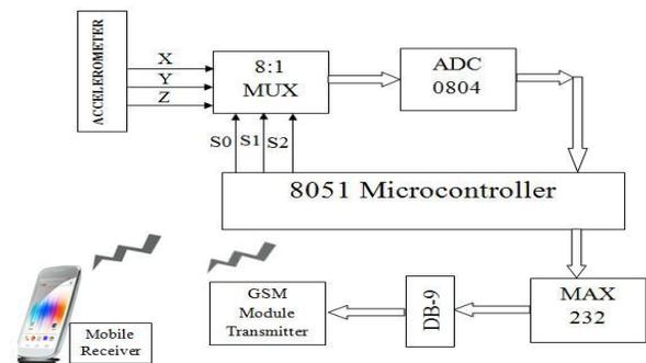
**Figure 1:** Block Diagramme of Tx & Rx Accelerometer
