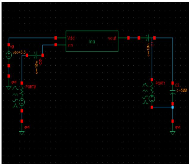
**Fig. 6 Test-bench of LNA**
